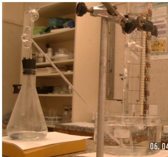
Controla la temperatura con el termómetro. Cuando los tubos hayan alcanzado el equilibrio térmico con el agua del vaso, arranca el reloj y añade con cuidado el ácido al tubo que contiene el cinc, tápalo con el tapón y el tubo acodado y recoge el gas en la probeta invertida. Anota los resultados en una tabla  $V(\text{cm}^3)\text{-}t$  (s).
